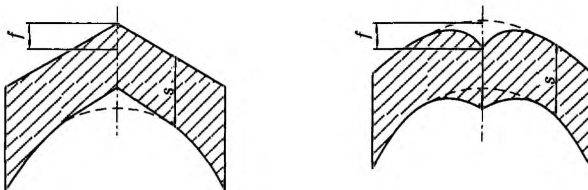
Рис. 1. Увод (угловатость) кромок в сварных швах
