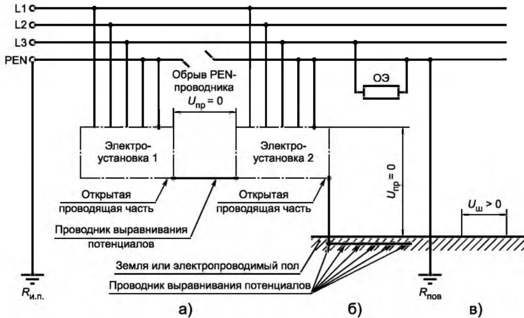
$U_{пр}$  — напряжение прикосновения, на участке а) оно равно нулю, на участке б) — близко к нулю;  $U_{ш}$  — шаговое напряжение, на участке б) оно близко к нулю, на участке в), где отсутствует выравнивание потенциалов, оно может достигать опасных для жизни людей и животных значений;  $R_{и.п.}$  — заземлитель источника питания;  $R_{пов}$  — заземлитель для повторного заземления PEN-проводника; ОЭ — однофазный электроприемник
