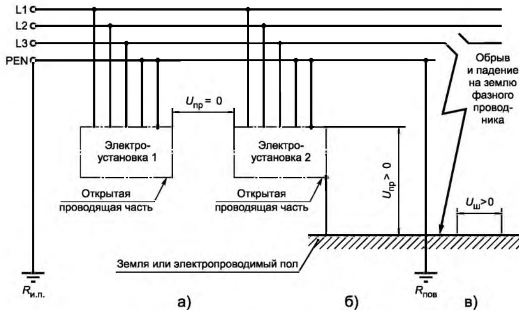
$U_{пр}$  — напряжение прикосновения;  $U_{ш}$  — шаговое напряжение;  $R_{и.п.}$  — заземлитель источника питания;  $R_{пов}$  — заземлитель для повторного заземления PEN-проводника
