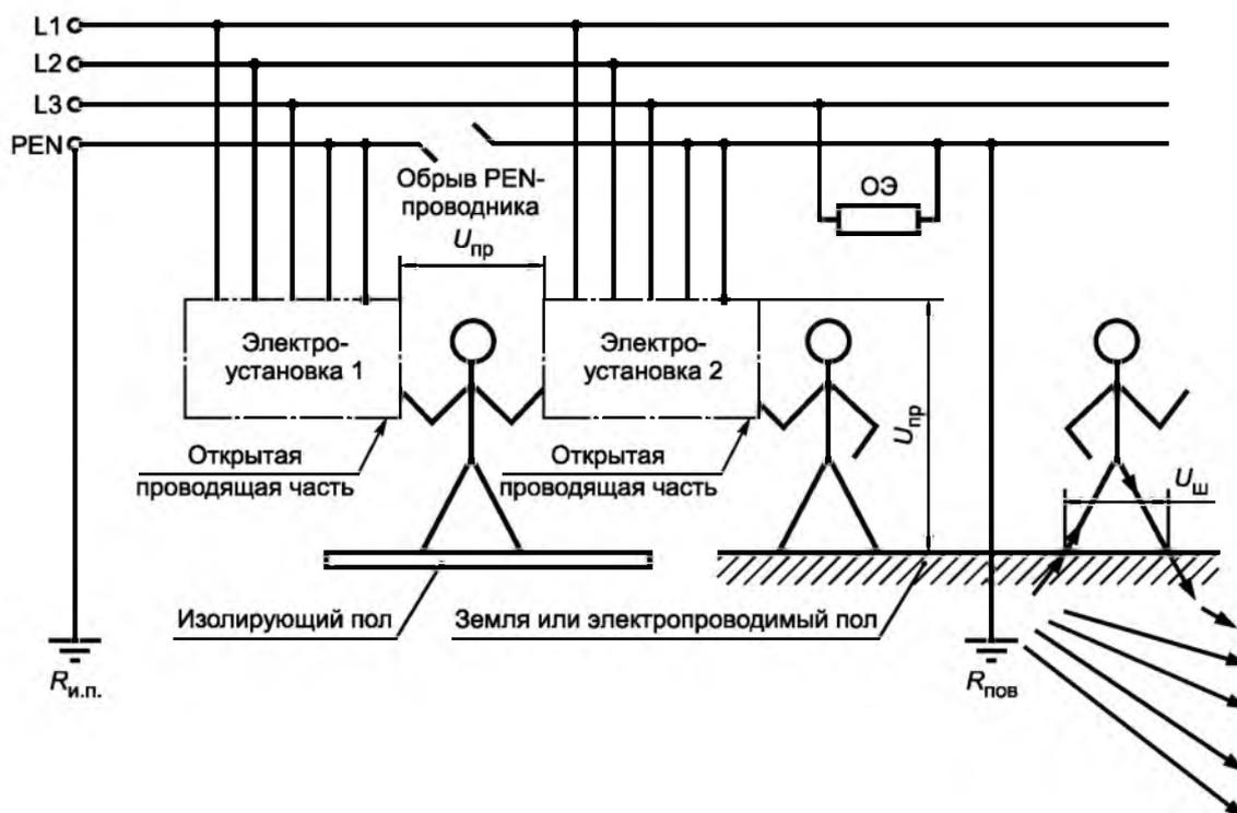
$U_{пр}$  — напряжение прикосновения;  $U_{ш}$  — шаговое напряжение;  $R_{и.п.}$  — заземлитель источника питания;  $R_{пов}$  — заземлитель для повторного заземления PEN-проводника; ОЭ — однофазный электроприемник
