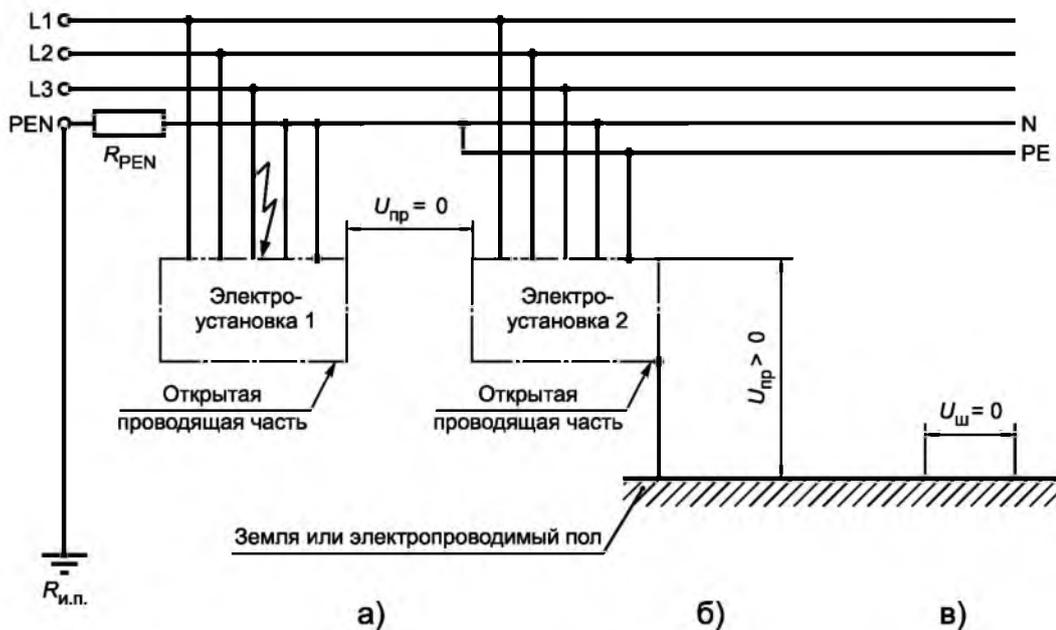
$U_{пр}$  — напряжение прикосновения;  $U_{ш}$  — шаговое напряжение;  $R_{и.п.}$  — заземлитель источника питания;  $R_{PEN}$  — сопротивление PEN-проводника
