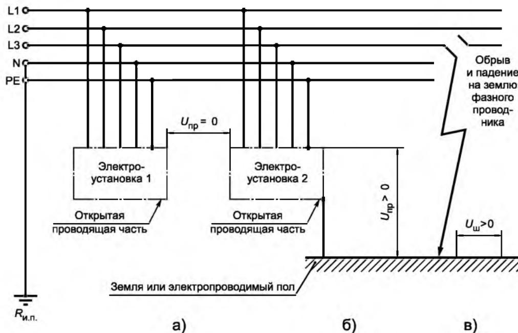
$U_{пр}$  — напряжение прикосновения;  $U_{ш}$  — шаговое напряжение;  $R_{и.п.}$  — заземлитель источника питания
