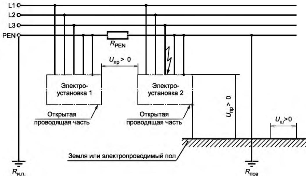
$U_{пр}$  — напряжение прикосновения;  $U_{ш}$  — шаговое напряжение;  $R_{и.п.}$  — заземлитель источника питания;  $R_{пов}$  — заземлитель для повторного заземления PEN-проводника;  $R_{PEN}$  — полное сопротивление PEN-проводника
