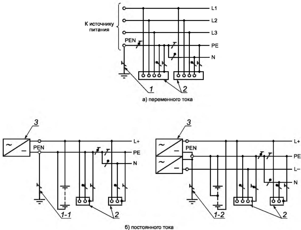
1 — заземлитель нейтрали источника переменного тока; 1-1 — заземлитель вывода источника постоянного тока; 1-2 — заземлитель средней точки источника постоянного тока; 2 — открытые проводящие части; 3 — источник питания
