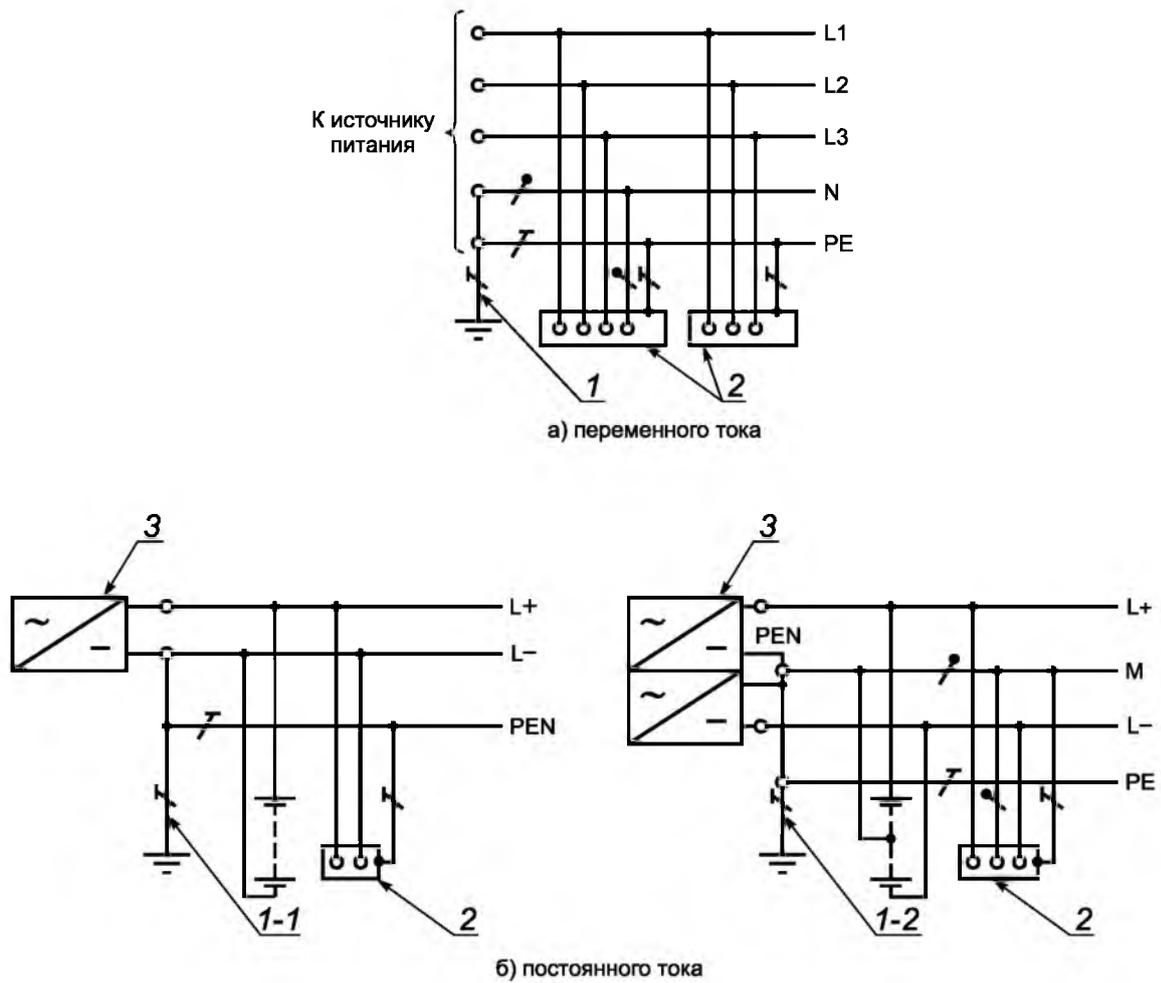
1 — заземлитель нейтрали источника переменного тока; 1-1 — заземлитель вывода источника постоянного тока; 1-2 — заземлитель средней точки источника постоянного тока; 2 — открытые проводящие части; 3 — источник питания
