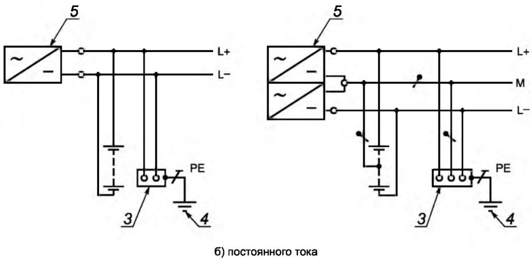
1 — сопротивление заземления нейтрали источника питания (если имеется); 2 — заземлитель; 3 — открытые проводящие части; 4 — заземляющее устройство электроустановки; 5 — источник питания
