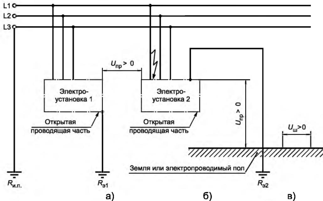
$U_{пр}$  — напряжение прикосновения;  $U_{ш}$  — шаговое напряжение;  $R_{и.п.}$  — заземлитель источника питания;  $R_{э1}$  — сопротивление заземления электроустановки 1;  $R_{э2}$  — сопротивление заземления электроустановки 2
