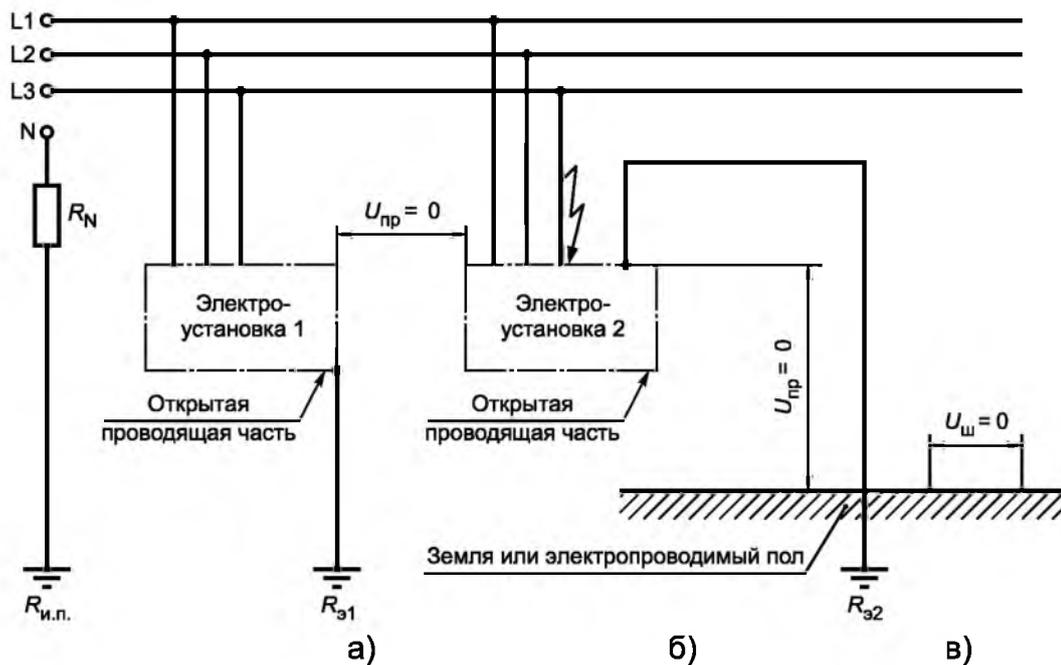
$U_{пр}$  — напряжение прикосновения;  $U_{ш}$  — шаговое напряжение;  $R_{и.п.}$  — заземлитель источника питания;  $R_{з1}$  — сопротивление заземления электроустановки 1;  $R_{з2}$  — сопротивление заземления электроустановки 2;  $R_N$  — сопротивление в заземляющем проводнике нейтрали источника питания
