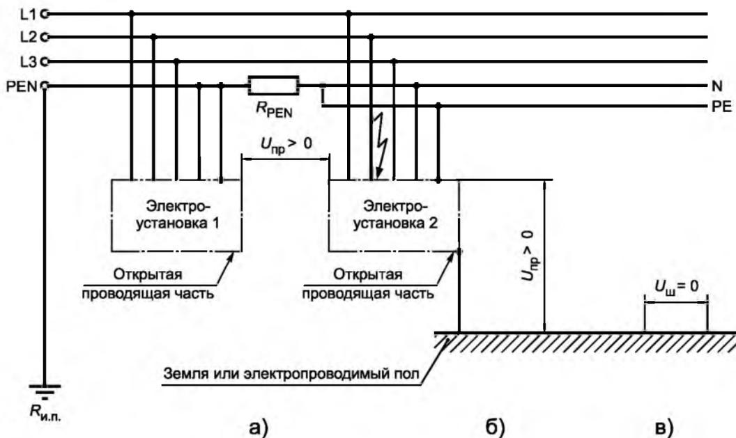
$U_{пр}$  — напряжение прикосновения;  $U_{ш}$  — шаговое напряжение;  $R_{и.п.}$  — заземлитель источника питания;  $R_{PEN}$  — полное сопротивление PEN-проводника
