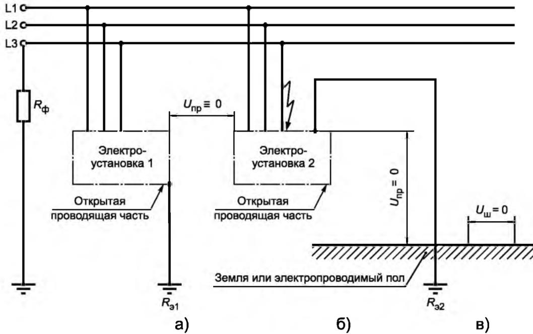
$U_{пр}$  — напряжение прикосновения;  $U_{ш}$  — шаговое напряжение;  $R_{и.п.}$  — заземлитель источника питания;  $R_{з1}$  — сопротивление заземления электроустановки 1;  $R_{з2}$  — сопротивление заземления электроустановки 2;  $R_\phi$  — сопротивление в заземляющем проводнике фазы источника питания
